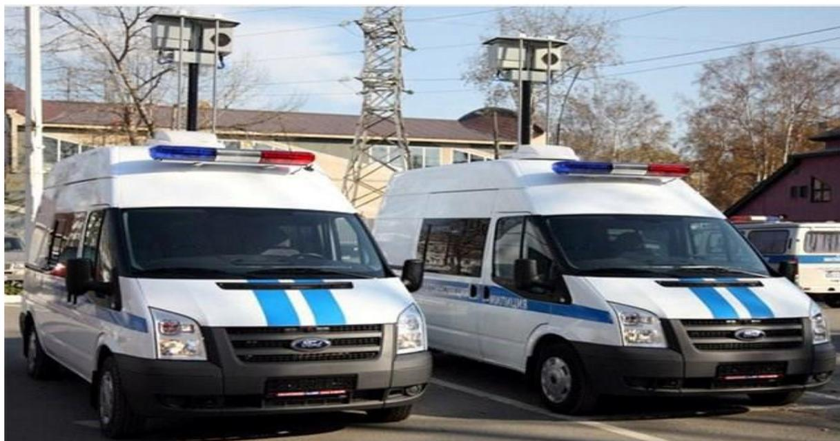
Автоматизированный мобильный комплекс контроля дорожного движения «Стрелка- М» предназначен для измерения скорости движения приближающихся и удаляющихся ТС, выделения и фиксации ТС относительно разметки на автомобильных дорогах и видеофиксации нарушений ПДД.
