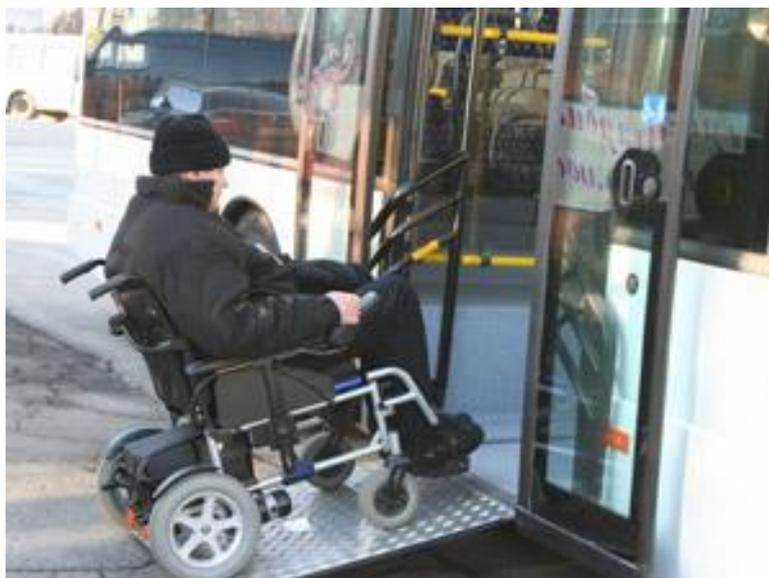
Рисунок 9 Организация посадки в низкопольный автобус инвалида- колясочника
