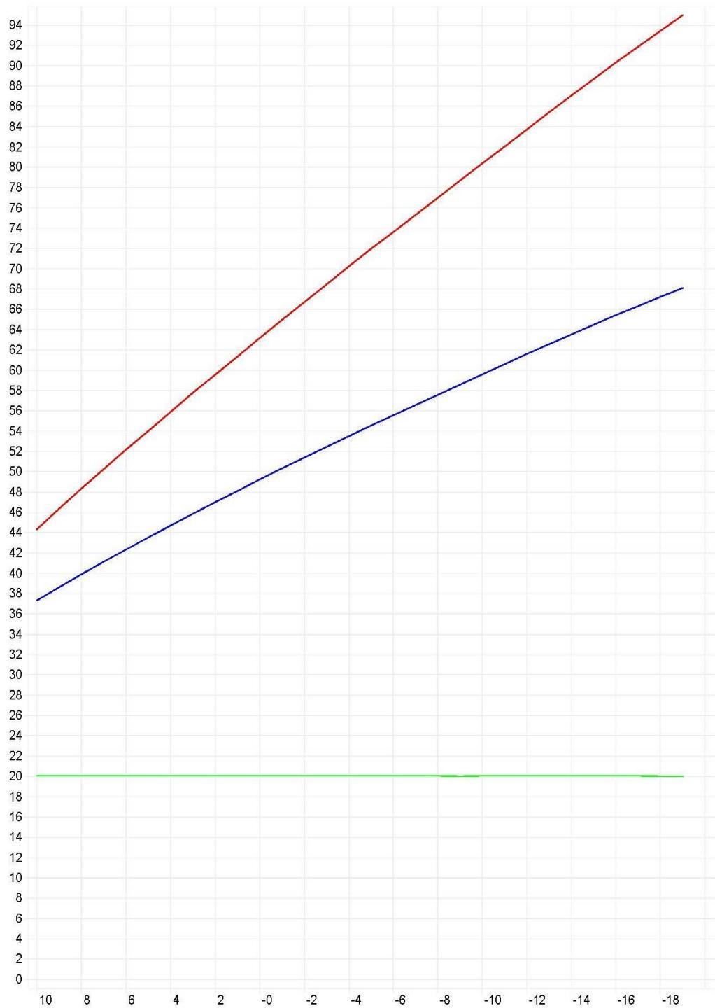
*Рисунок 5.8.1 – Расчет отпуска тепловой энергии для котельной Чепигинского сельского поселения Брюховецкого района в течение года при температурном графике 95-70 °C*
